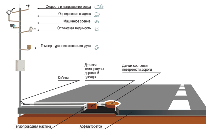
Рис. 1. Автоматическая дорожная метеорологическая станция
