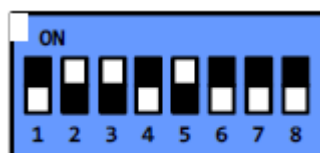
Рисунок 5. Конфигурация блока микропереключателей SW3. Настройка режима отображения
